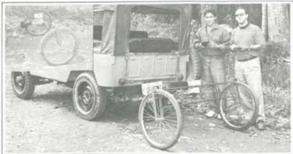
O Irregularímetro instalado em um veículo. No detalhe, o aparelho que ainda será aperfeiçoado.
