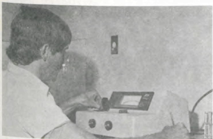
Neste aparelho de absorção atômica é determinado o cálcio em material vegetal.
