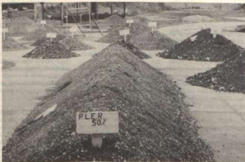
Compostagem de um lote de lodo pelo processo de aeração.
