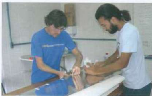
Com a orientação de Robson (à esq.), a equipe começa a revestir o asso da aeronave
